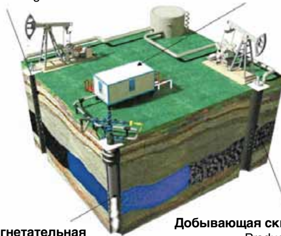
Рис.3. Принципиальная схема реализации термогазового воздействия
