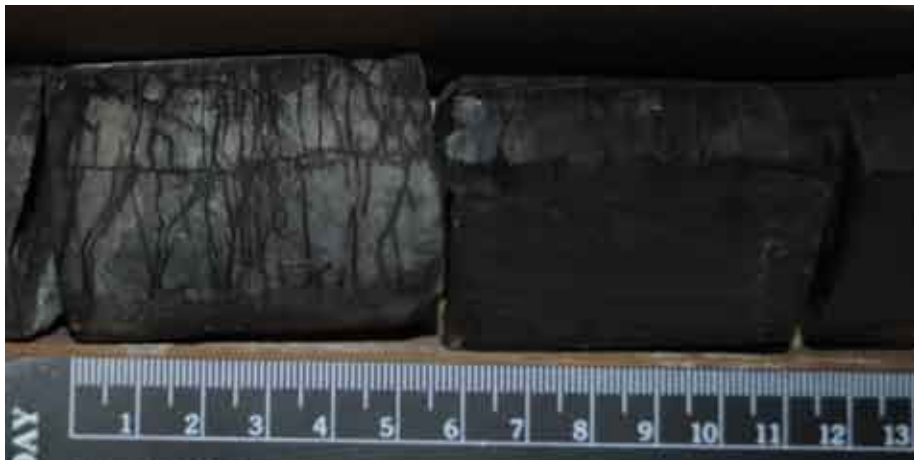
Рис. 4. Густая сеть техногенных трещин, развитых на «горбушке» керна (а), и отсутствие трещины внутри керна (б)
