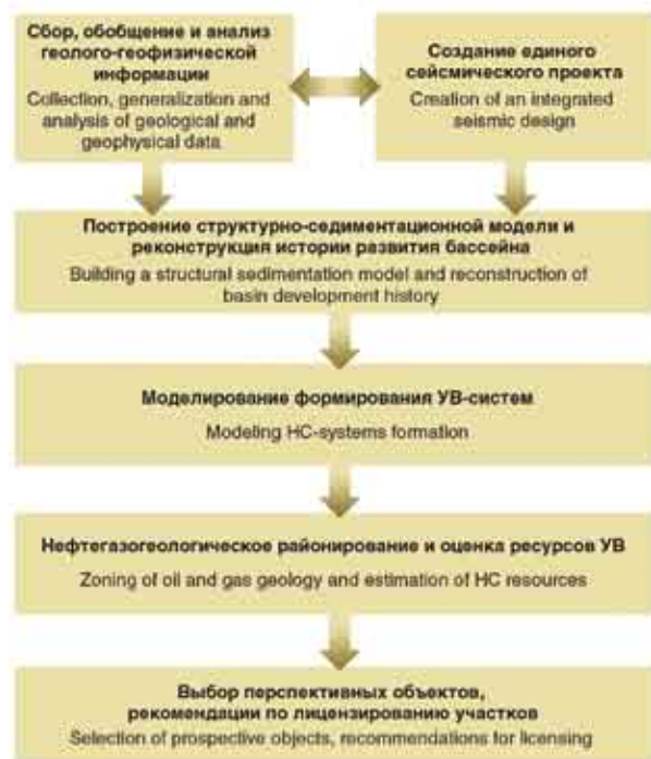
Рисунок 1: Методологический подход к оценке перспектив нефтегазоносности осадочных бассейнов Figure 1: Methodological approach to evaluation of oil and gas potential of sedimentary basins
