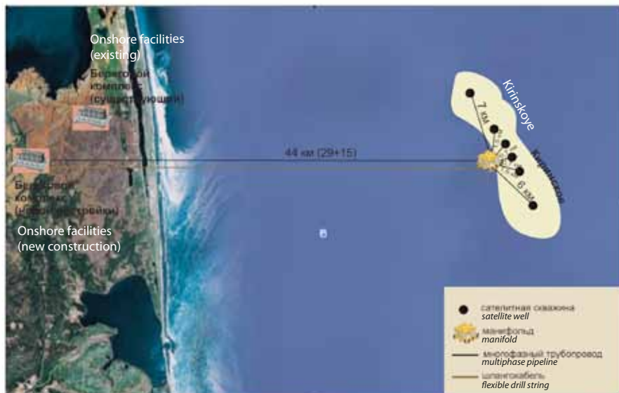
Рисунок 2: Схема обустройства Киринского ГКМ Image 2: Kirinskoye GCF
