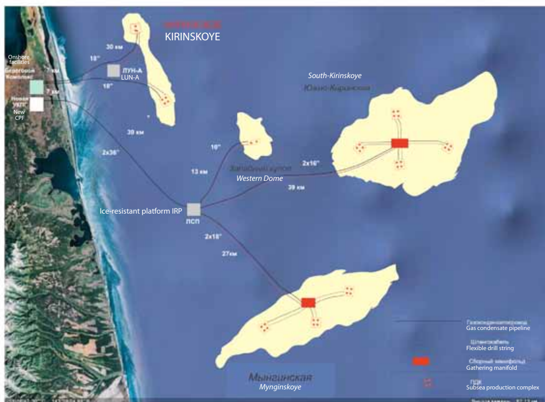
Рисунок 4: Схема обустройства Кириного блока по варианту 2 Image 4: Field facilities layout for Kirinskoye block, option 2
