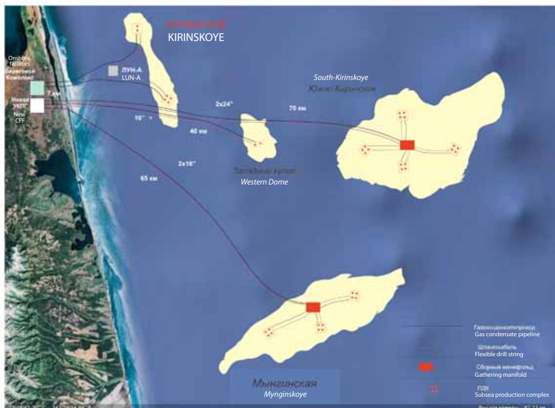
Рисунок 3: Схема обустройства Кириного блока по варианту 1 Image 3: Field facilities layout for Kirinskoye block, option 1
