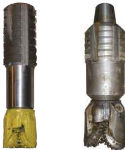
Рис.1. Реактивно-акустические модули 124,0 и 215,9 мм для бурения наклонно-направленных и горизонтальных скважин.
