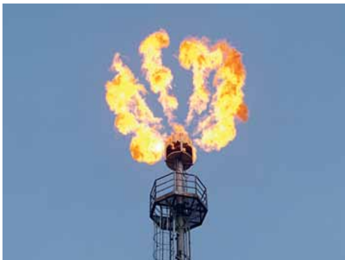
Факела ЦПС и УПСВ Верх-Тарского нефтяного месторождения после модернизации. Бессажеевое горение. Flares at Verkh-Tarskoye CPF and free water knockout station after the upgrade. Soot-free combustion.
