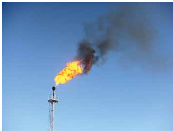
Факел высокого давления ЦПС Верх-Тарского нефтяного месторождения до модернизации. Горение с выделением сажи.
