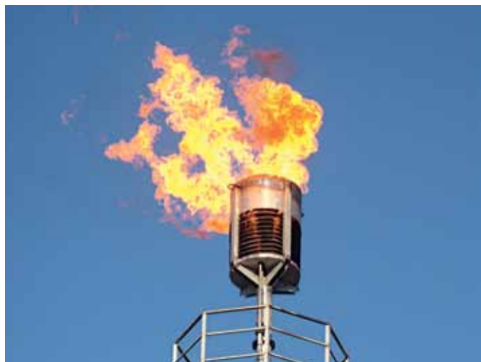
Факела ЦПС и УПСВ Верх-Тарского нефтяного месторождения после модернизации. Бессажеевое горение. Flares at Verkh-Tarskoye CPF and free water knockout station after the upgrade. Soot-free combustion.
