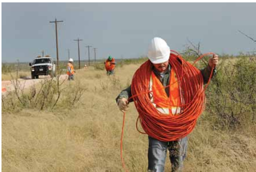
Кабели и «ручная откатка»; фото предоставлено Wireless Seismic Inc. Cables and 'man-hauling'; picture courtesy of Wireless Seismic Inc.
