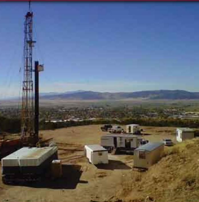
**Радиальное бурение** является эффективным методом повышения нефтеотдачи существующих нефтяных и газовых скважин. В горизонтальной плоскости в стороны от основного ствола формируются боковые стволы длиной до 100 м, которые создают дополнительные каналы для притока жидкость, а также позволяют проводить химические обработки, ГРП и закачку пара. Компания RDS — мировой лидер в радиальном бурении — пробурила более 5000 боковых стволов с использованием собственной запатентованной технологии.
