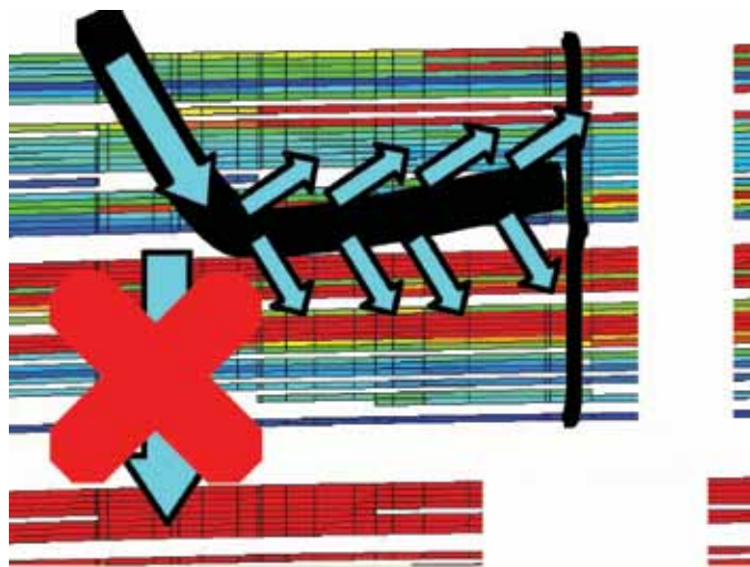
Рис. 3 Адресная закачка в пласт АВ1(1-2) «Рябчик» через горизонтальные скважины ППД
