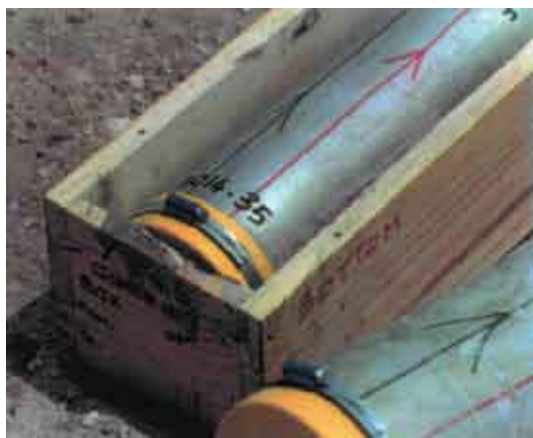
Рис. 4 Фото пеналов и тубусов с керном Fig.4 Picture of the cases and tubes with a core
