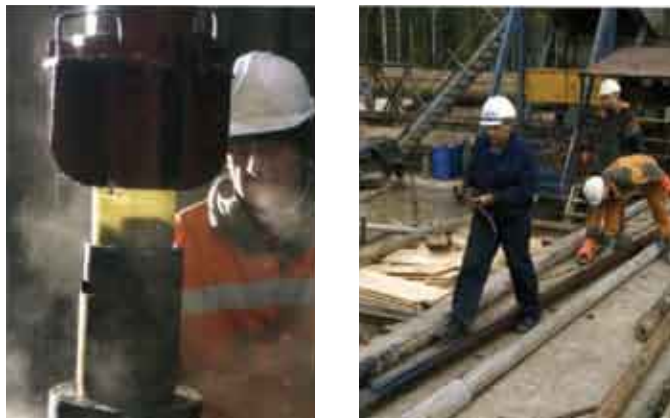
Рис.3 Операция по извлечению изолированных пеналов с керном из керноотборного снаряда Fig.3 Withdrawal of Isolated Cases with Core from the Core Retrieving Barrel
