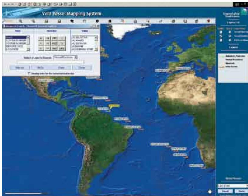
Сочетание ГИС и GPS-технологий позволяет в реальном времени отслеживать положение и движение множества объектов в любом масштабе - от города до всей Земли. In combination with GPS, GIS can track down on-line positions and travel trajectories of multiple objects, in any scale required (within a town or around the Globe)
