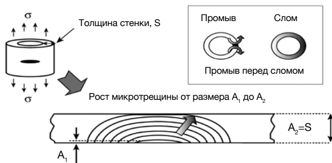
Рис. 1. Развитие микротрещины в теле бурильной трубы
