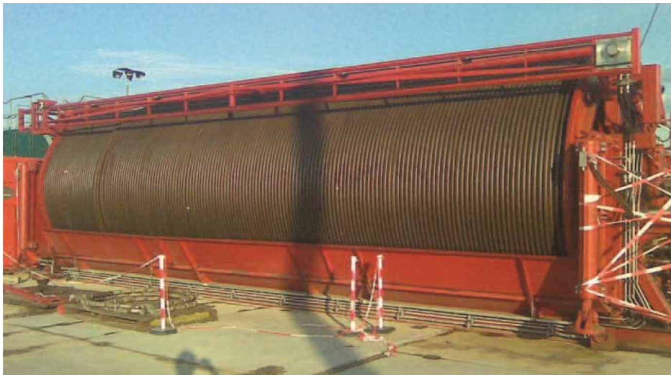
Рис. 3. Установка с нестандартно расположенным барабаном с гибкой трубой диаметром 2 3/8" длиной 9000 м Fig 3. A unit with non-standard reel positioning accommodating 9000m of coiled tubing with a diameter of 2 3/8"
