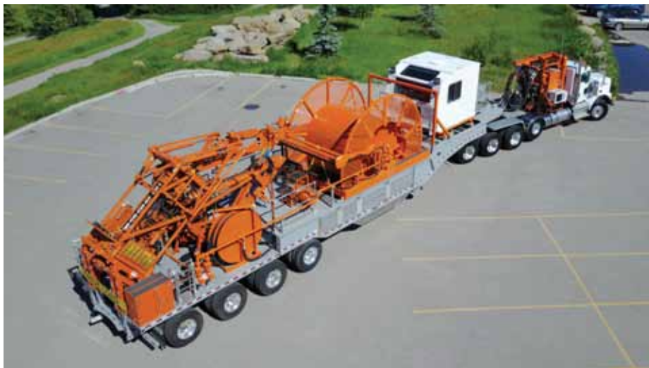
Рис. 2. Установка ГНКТ повышенной грузоподъемности (NOV) 2 7/8": а – вид сбоку; б – вид сверху
