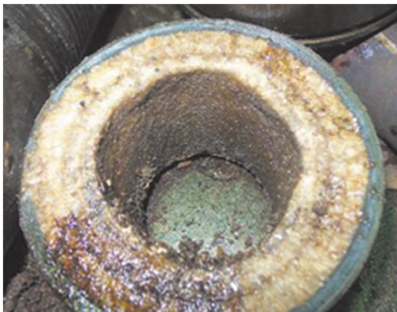
Рис. 1.10. Уменьшение внутреннего диаметра НКТ в результате солеотложений (внутренний диаметр уменьшился на 37,6 %, площадь проходного сечения – на 60,5 %). Западно-Салымское месторождение (Нефтеюганский район), 2016 г. Дебит скважины по нефти 14,2 т/сут., обводненность 76,8 %. Снижение дебита скважины. Состав отложений (% мас.):
