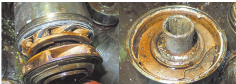
Рис. 1.1. Солеотложения на рабочих колесах УЭЦН. Западно-Салымское месторождение (Нефтеюганский район), 2016 г. Дебит скважины по нефти 12,1 т/сут., обводненность 74,5 %. Состав отложений (% мас.): \text{CaCO}_3 – 78; другое (песок, глина, соединения железа) – 22
