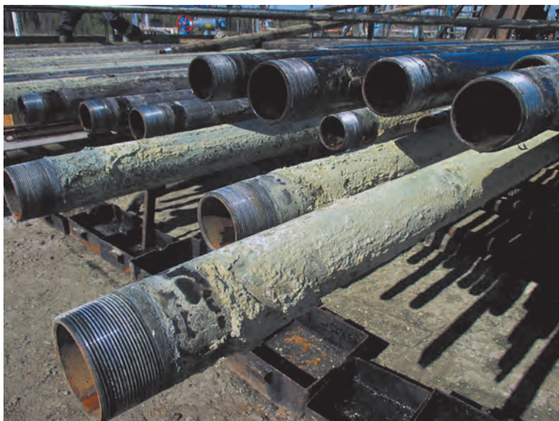
Рис. 7.6. Скважина Б. Отложения ИСО на наружной поверхности НКТ. Западно-Салымское месторождение, Нефтеюганский район, 2016 г.
