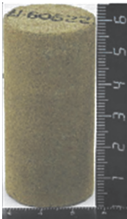
Рис. 6.17. Образец породы из керна, отобранного из добывающей скважины Пильтун-Астохского месторождения
