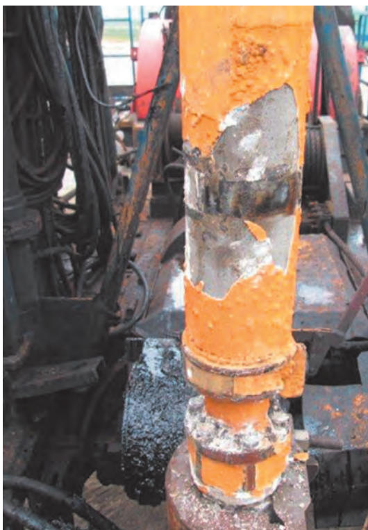
Рис. 1.4. Солеотложения на корпусе секции насоса УЭЦН. Колвинское месторождение (Архангельская область), 2016 г. Дебит скважины по нефти 16,0 т/сут., обводненность 70,0 %. Состав отложений (% мас.): \text{CaSO}_4 – 79; \text{CaCO}_3 – 12; другое (песок, глина, соединения железа) – 9
