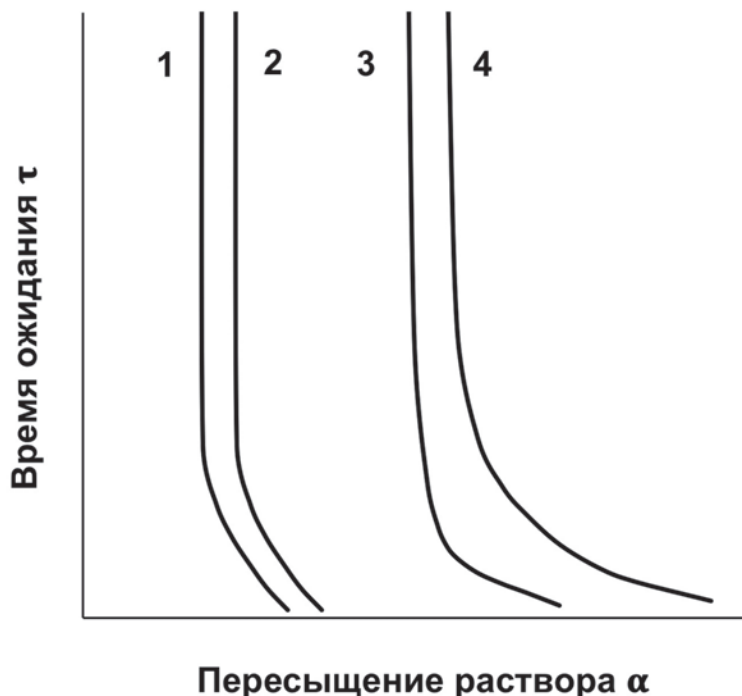
Рис. 3.5. Зависимость времени ожидания начала кристаллизации \tau от пересыщения раствора \alpha : 1, 2, 3 – водные растворы KI, KBr, KCl соответственно; 4 – водно-спиртовой раствор KCl [57]
