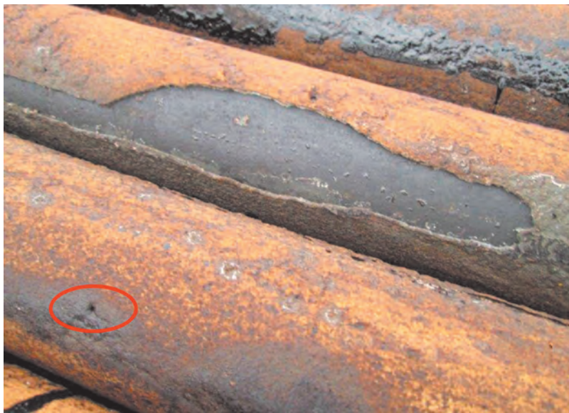
Рис. 1.8. Солеотложения на наружной поверхности НКТ. Колвинское месторождение (Архангельская область), 2016 г. Дебит скважины по нефти 16,0 т/сут., обводненность 70,0 %. Снижение дебита скважины в результате негерметичности НКТ. Состав отложений (% мас.): \text{CaSO}_4 – 86; \text{CaCO}_3 – 9; другое (песок, глина, соединения железа) – 5
