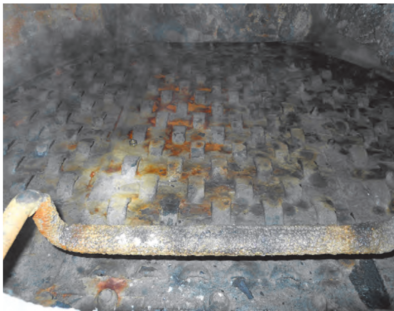
Рис. 1.30. Отложения в отпарной колонне МЭГ берегового технологического комплекса
