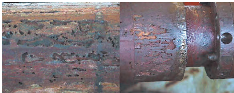
Рис. 1.5. Мейза-коррозия корпуса ПЭД, глубина проникновения 26 мм/год. Ван-Еганское месторождение (Нижневартовский район), 2000 г. Отказ УЭЦН (отсутствие подачи) через 85 сут. после начала работы скважины, причина отказа – выход из строя ПЭД вследствие сквозной коррозии корпуса
