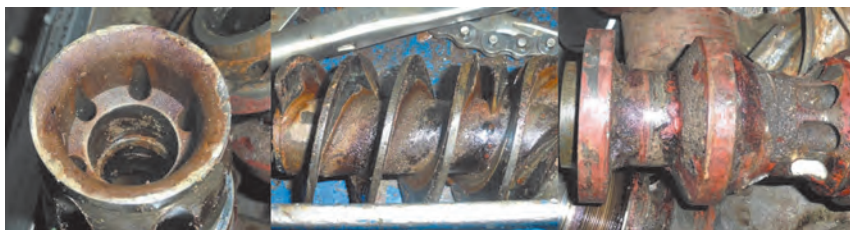
Рис. 1.3. Солеотложения в газосепараторе УЭЦН. Верхне-Салымское месторождение (Нефтеюганский район), 2015 г. Дебит скважины по нефти 5,0 т/сут., обводненность 82,8 %. Состав отложений (% мас.): \text{CaCO}_3 – 37; другое (песок, глина, соединения железа) – 63
