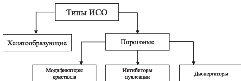
Рис. 6.1. Классификация ингибиторов солеотложений по механизму действия
