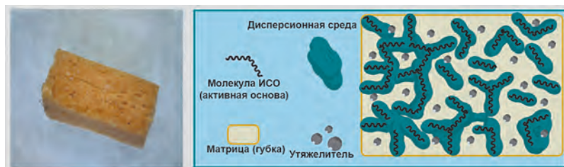
Рис. 7.14. Схема капсулированного ИСО «Губка» [194]
