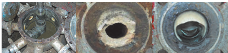
Рис. 1.14. Солеотложения в ПСМ. Талинское месторождение (г. Нягань), 2007 г. Уменьшение внутреннего диаметра подводящих патрубков ПСМ (внутренний диаметр уменьшился на 57,5 %, площадь проходного сечения – на 81,9 %), заклинивание каретки ПСМ. Состав отложений (% мас.): \text{CaCO}_3 – 84; другое (песок, соединения железа) – 16
