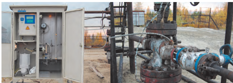
Рис. 7.8. Ввод капиллярной трубки через боковой отвод устьевой арматуры
