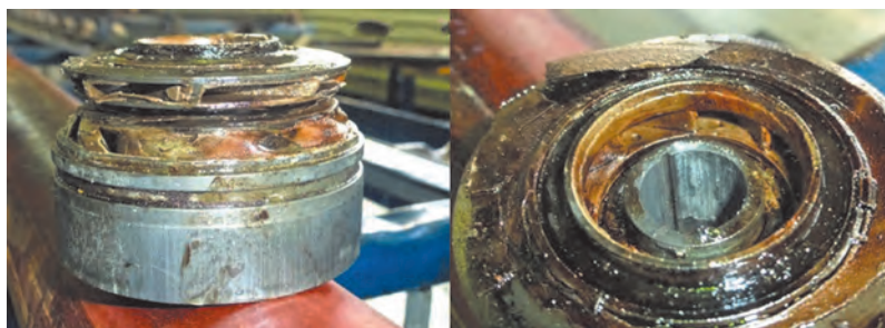
Рис. 1.2. Солеотложения на рабочих колесах УЭЦН. Верхне-Салымское месторождение (Нефтеюганский район), 2015 г. Дебит скважины по нефти 5,0 т/сут., обводненность 82,8 %. Состав отложений (% мас.): \text{CaCO}_3 – 87; другое (песок, глина, соединения железа) – 13
