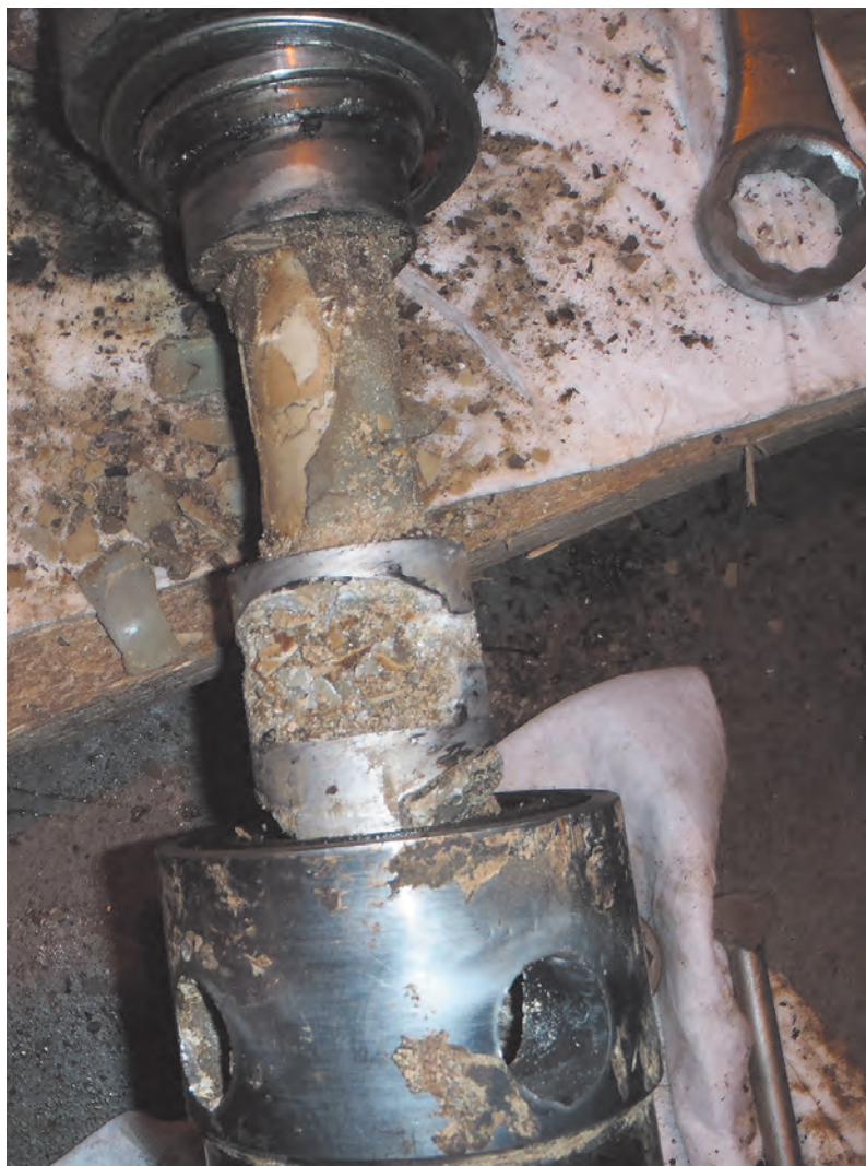
Рис. 1.26. Солеотложения в насосе низкого давления системы ППД морской добывающей платформы ПА-Б. Пильтун-Астохское месторождение (о. Сахалин, шельф), 2013 г. Состав отложений (% мас.): \text{CaCO}_3 – 94; \text{BaSO}_4 – 4; песок, оксиды железа – 2
