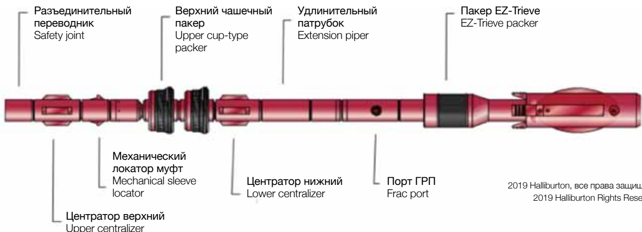
Рис. 6: Схема двухпакерной компоновки Fig. 6: Dual-packer assembly schematic
