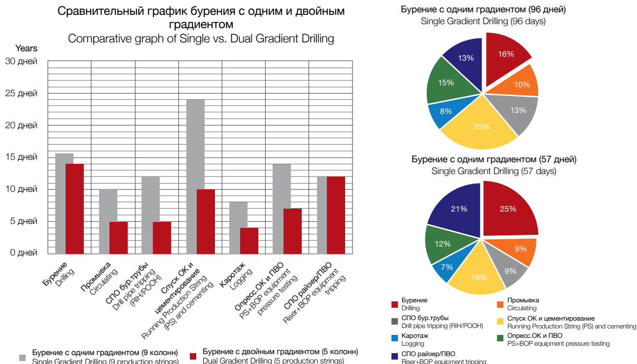
Рис.5: Сравнительный расчетный график традиционного и бурения с двойным градиентом для скважины в Черном море Fig.5: Comparative design chart of the conventional and dual gradient drilling for a well in the Black Sea
