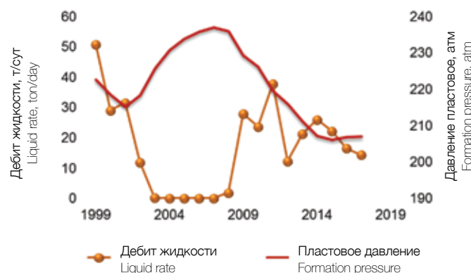
Рис. 1: Энергетическая характеристика объекта ДЮК. Восточно-Ингинский ЛУ Красноленинского месторождения Fig. 1: The energy characteristic of the pre-Jurassic complex target at the Vostochno-Inginsky license area, the Krasnoleninskoye field
